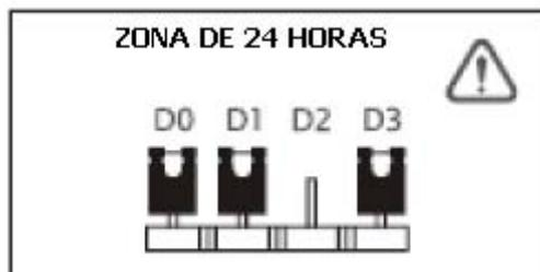
**Nota:** si utiliza sensores de gas o de humo, la configuración recomendada es la de 24 horas.
