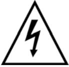
Este símbolo pretende alertar al usuario de la presencia de un “voltaje peligroso” sin protección dentro de la carcasa del producto que podría ser lo suficientemente alta para suponer un riesgo de electrocución.
