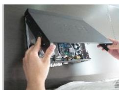
Coloque la cubierta superior
