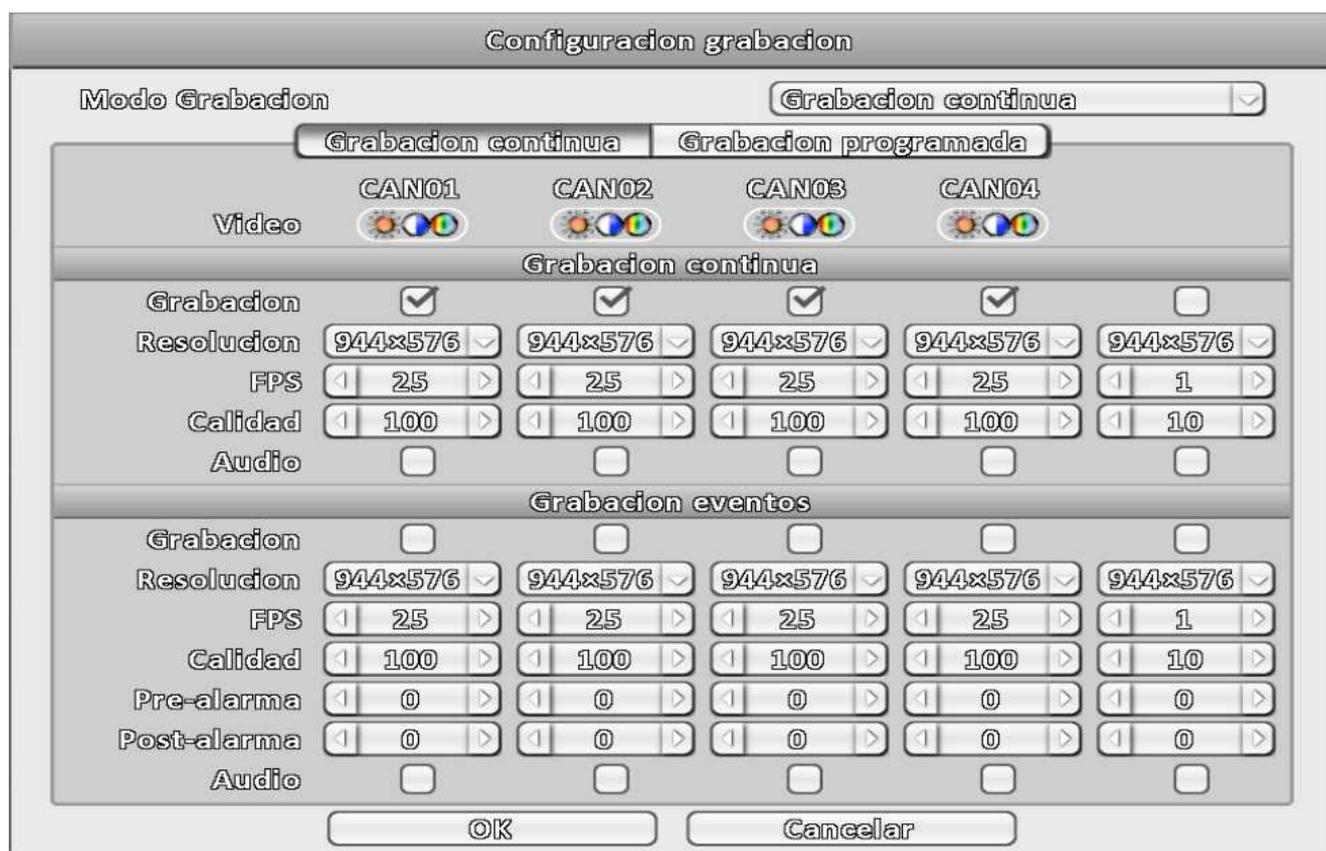
Seleccione las casillas correspondientes de cada canal (CAN01, CAN02---CAN04) y especifique la resolución, frames por segundo, calidad de vídeo y audio que desee para cada canal.
