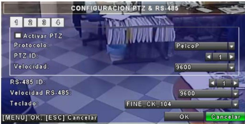
El DVR permite a los usuarios controlar las funciones PTZ de su cámara. Para activar la función PTZ, debe conectar el cable RS-485 al puerto RS-485 del DVR.
