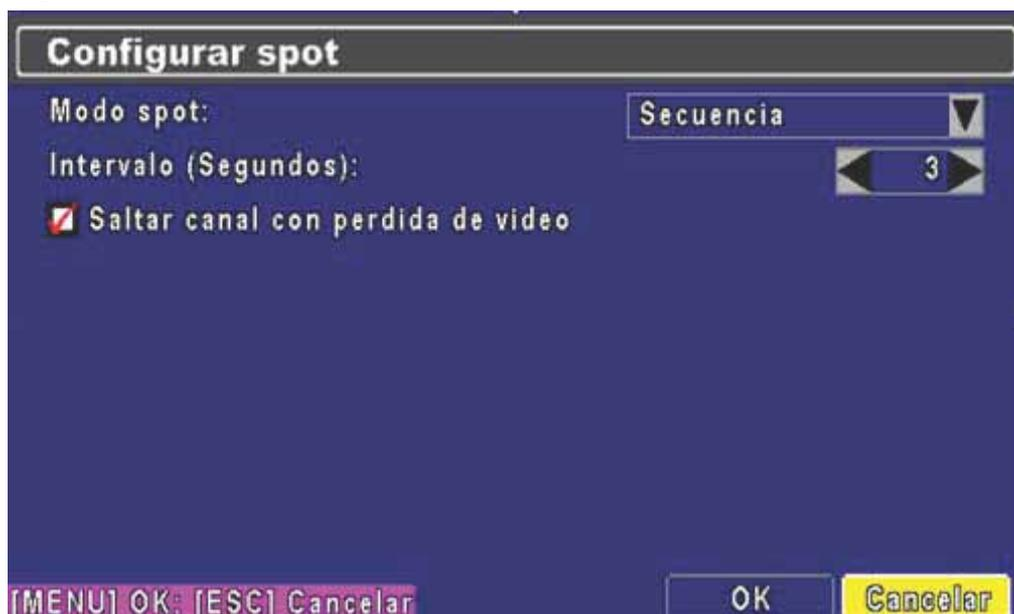
El DVR tiene dos modos de salida de vídeo; una es la salida de vídeo principal y la otra es la salida de vídeo para un segundo monitor (SPOT). Esta opción permite controlar el orden de los canales para verlos secuenciales en el modo SPOT. El usuario puede monitorizar cada canal en el modo SPOT.
