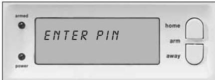
Introduzca el código PIN de 4 dígitos (configuración de fábrica 0000. Vea 8.3 para cambiar el código PIN). Por cada dígito que usted introduzca, aparecerá un \* en la pantalla. Cuando el código PIN ha sido introducido correctamente, la primera opción del menú será mostrada en la pantalla..
