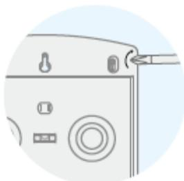
**4** Coloque la base presionando con cuidado y vuelva a poner la carcasa de la sirena con las pestañas. Coloque de nuevo los tornillos situados en la parte inferior de la sirena para fijar la carcasa. No apriete demasiado los tornillos o podría dañar la rosca.
