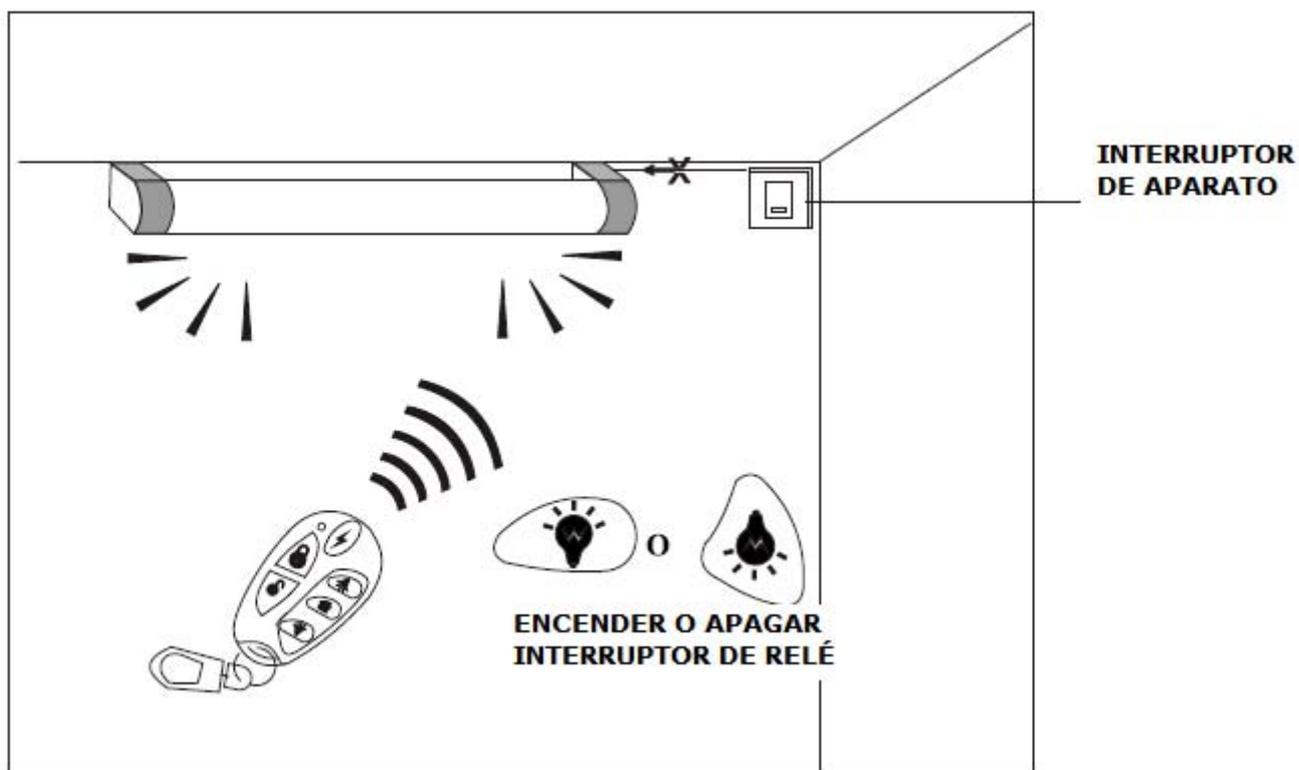
5. Puede controlar hasta 48 aparatos remotamente pulsando los botones de bombillas de encendido/apagado.
