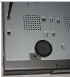
Fig 2.2 Atornillar el HDD
