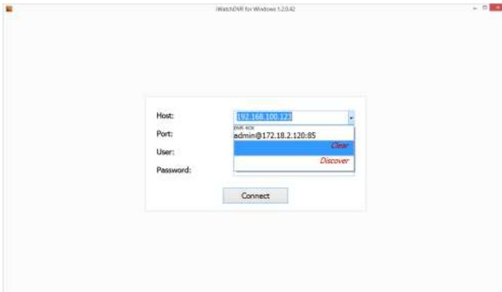
El menú desplegable puede ser usado para recordar direcciones IP. Pulsando en "Clear" se borra la lista de direcciones almacenadas.
