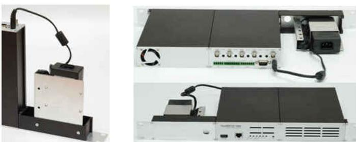
G. Conecte el cable de alimentación al conector de alimentación. La instalación del rack ya ha terminado
